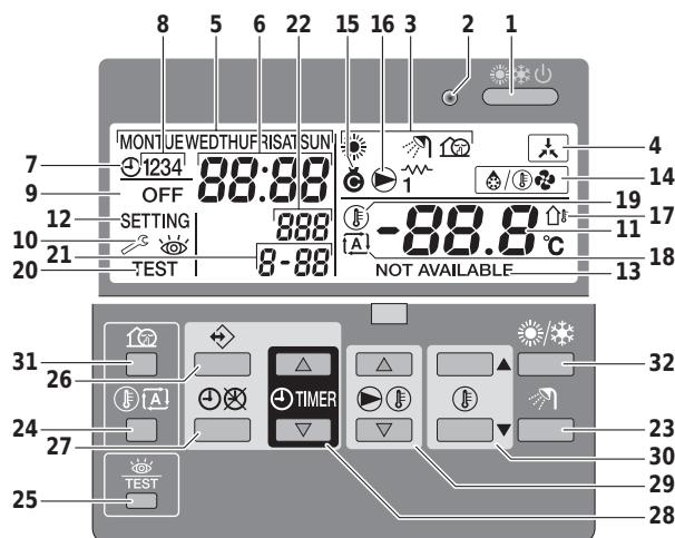
1. ΚΟΥΜΠΙ ΕΝΕΡΓΟΠΟΙΗΣΗΣ/ΑΠΕΝΕΡΓΟΠΟΙΗΣΗΣ Το κουμπί ΕΝΕΡΓΟΠΟΙΗΣΗΣ/ΑΠΕΝΕΡΓΟΠΟΙΗΣΗΣ ξεκινά ή τερματίζει τη θέρμανση/ψύξη χώρου. Το συνεχόμενο πάτημα του πλήκτρου ΕΝΕΡΓΟΠΟΙΗΣΗΣ/ΑΠΕΝΕΡΓΟΠΟΙΗΣΗΣ πολλές φορές μπορεί να οδηγήσει σε δυσλειτουργία του συστήματος (μέγιστος αριθμός 20 φορές ανά ώρα).
